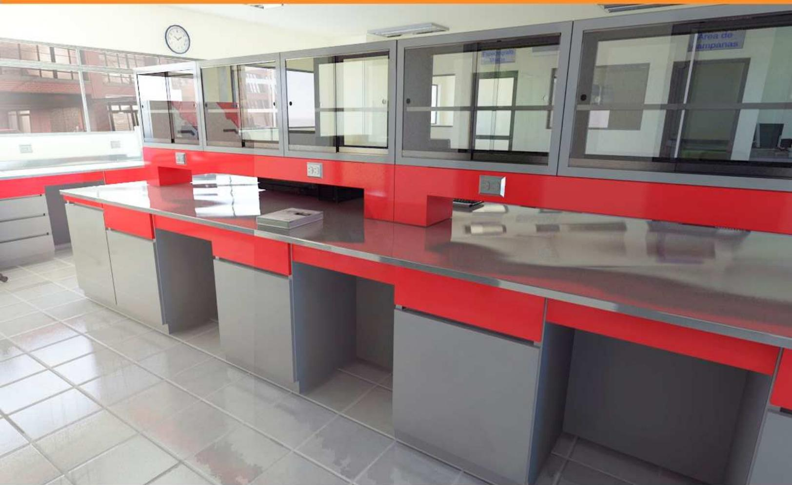
Cubiertas de acero inoxidable fabricadas en acero inoxidable T-304 o 316, calibre 18 con acabado pulido. Las cubiertas pueden o no llevar respaldo. El respaldo ayuda a proteger la pared y a su vez evita derrames de líquidos o que caigan objetos a la parte posterior de la mesa. El fondo de cada cubierta depende de la necesidad del laboratorio. Consulte las medidas estándar en [www.dabrielo.com/manuales](http://www.dabrielo.com/manuales)
